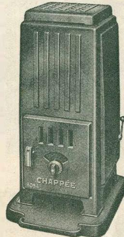
Calorifère à feu visible, en fonte émaillée, permettant l'utilisation de tous combustibles : charbons anthraciteux ou coke, calibre 20 x 30. Cet appareil à combustion à travers la masse, et à départ direct a été spécialement étudié en vue d'obtenir le maximum d'économie de combustible. Economie, haut rendement, facilité de décentrage et de nettoyage.
