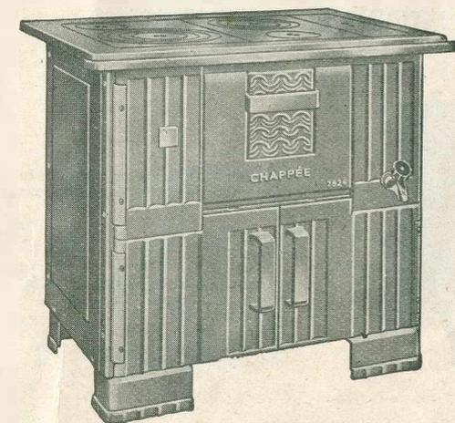
Cuisinière corps acier, façade et côtés fonte émaillée, à retour de flammes. Dessus meulé à quatre trous. Buse ovale au milieu, dessus ou derrière. Foyer mixte. Chaudière affleurante. Barre devant. Porte de four abattante équilibrée. Portes d'étuve ouvrantes.
